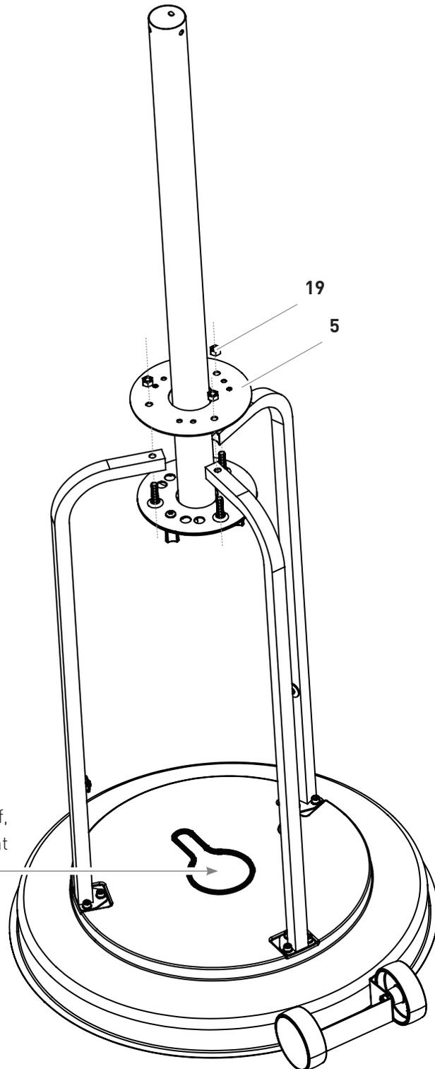
■ Achten Sie beim Versenken der Säule darauf, dass der Schlauch in der Schlauchöffnung nicht eingeklemmt wird.
